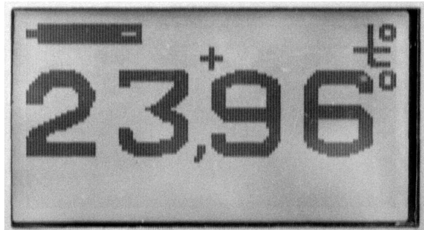
Рис.10. Пример экрана в режиме измерения температуры грунта
